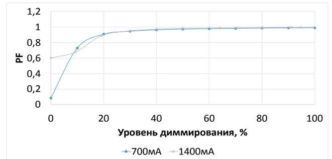
Все параметры измерены при напряжении питания 220В AC и номинальной нагрузке при 25° C окружающей среды.
